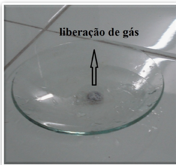
Figura 12 - Simulação em vidro de relógio da reação do carbeto de cálcio com a água produzindo o gás etino na etapa teórico-experimental.
