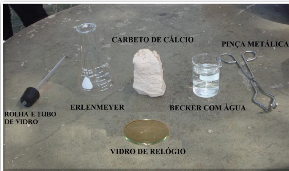
Figura 11- Vidrarias, utensílios e reagentes utilizados no experimento produção de etino na etapa teórico-experimental.
