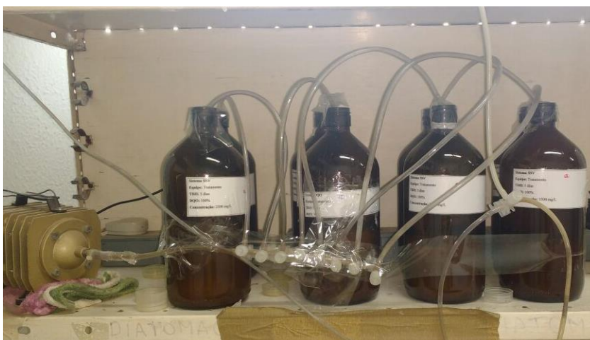
Figura 7: Reatores aeróbios, em batelada, utilizado para biodegradabilidade do efluente.
