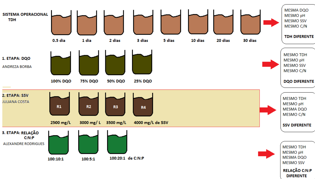
Figura 4: Esquema de montagem dos sistemas e suas etapas: TDH, DQO, SSV e relação C:N:P.
