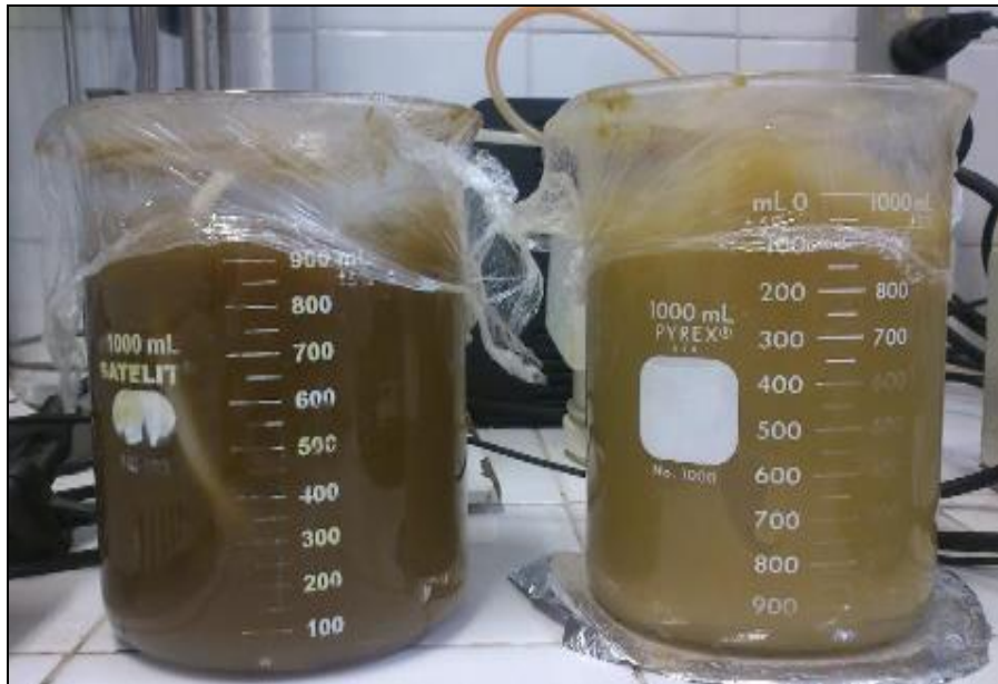
Figura 5: À esquerda, o lodo proveniente do sistema de lodos ativados que tratava efluente de cervejaria e, à direita, de um filtro submerso, que tratava glicerol residual.
