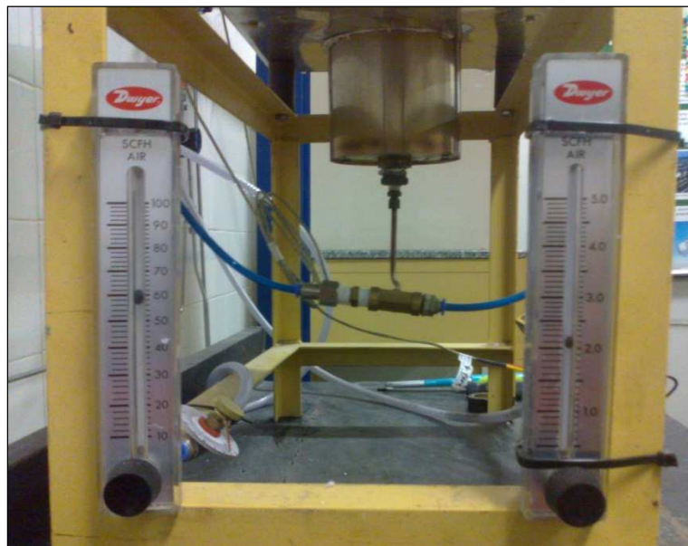
Figura 20 – Queimador volumétrico utilizado no forno
