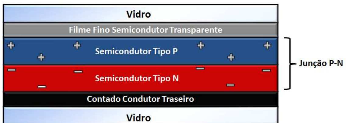
Figura 4 - Esquema de uma Célula Solar de Filmes Finos
