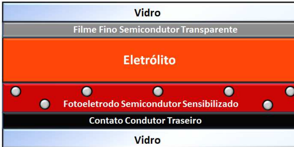
Figura 3 - Esquema de uma Célula Solar Fotoeletroquímica
