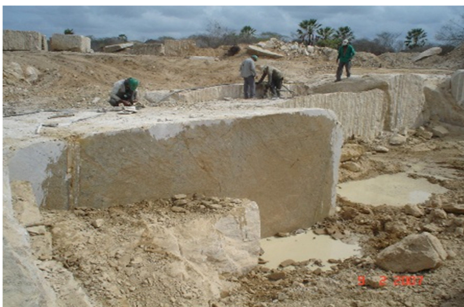
Foto 2.3 – Pedreira granito Kashmir, com abertura de frente de lavra por meio de bancadas baixas (Fonte: Autor).
