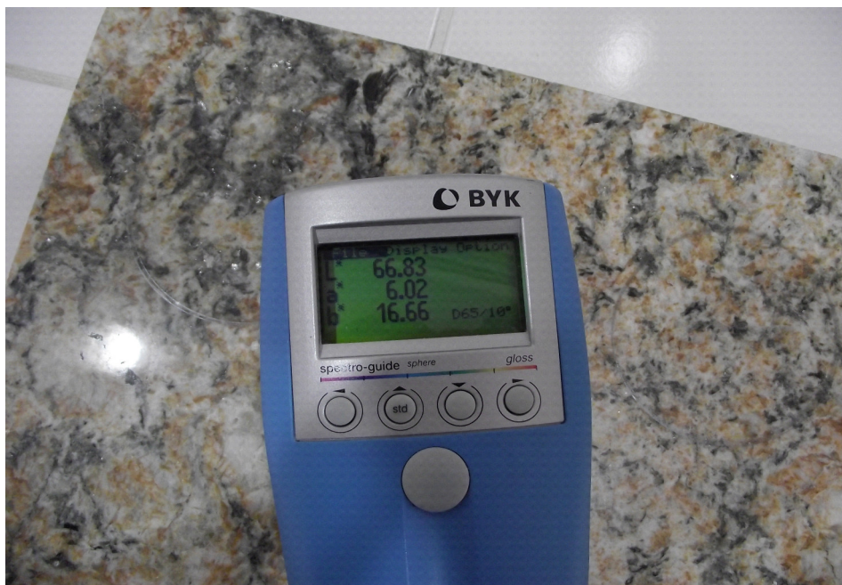
Foto 5.7- Aparelho utilizado para medição do índice de cor (Fonte: Autor)
