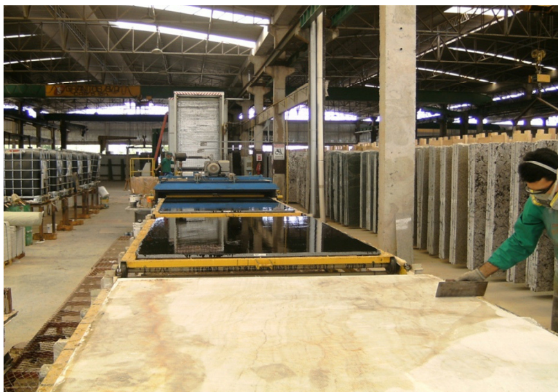
Foto 3.3 – Linha de resinagem de chapa sistema a vácuo, Empresa GRANOS (Fonte: Autor).
