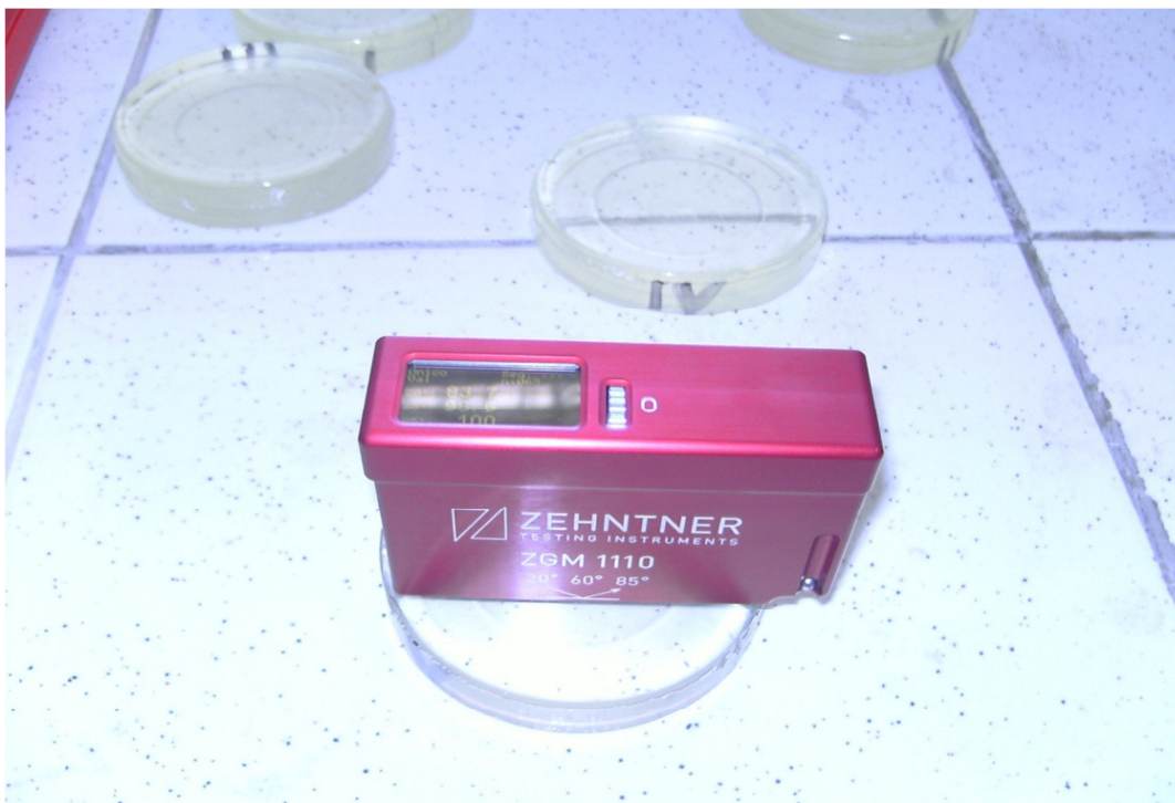
Foto 6.6: Medição de brilho da resina antes e após ataque com os ácidos
