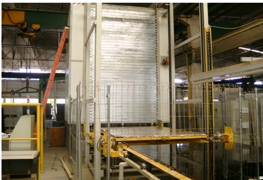
Foto 3.4 – Forno utilizado pela Granos para apressar a cura, que é a secagem da mistura resina e catalizador. (Fonte: Autor)
