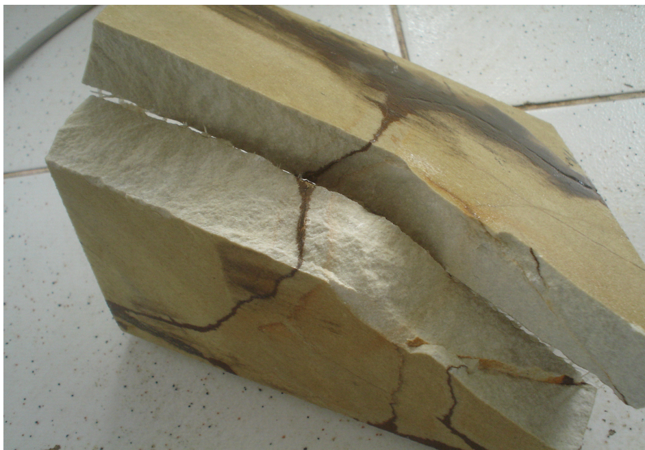
Foto 6.5: O rompimento do corpo de prova resinado ocorreu em direção Perpendicular ao plano de maior fraqueza da rocha (Fonte: Autor).
