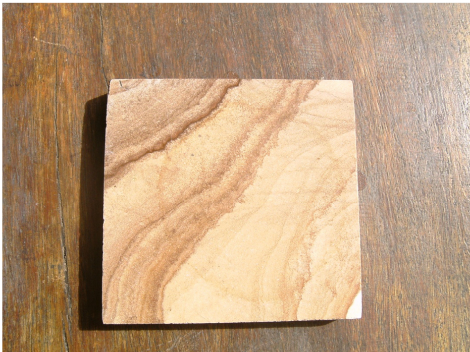
Foto.6.7: Efeito do ácido cítrico na variação total de cor do granito Wood Stone em seu estado natural
