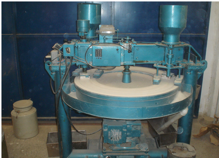
Foto 5.6 Máquina do NUTEC, utilizada para cálculo do Desgaste AMSLER em amostras de rochas ornamentais (Fonte: Autor).
