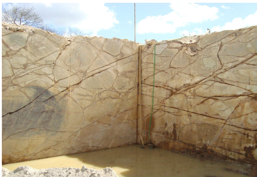
Foto 3.1 – Extração a fio diamantado de um material exótico altamente fraturado. Pedreira do granito Wood Stone (Fonte: Autor).
