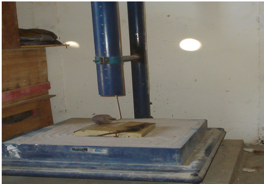
Foto 5.4 Equipamento do NUTEC, utilizado para determinar a resistência ao impacto de corpo duro (Fonte: autor)
