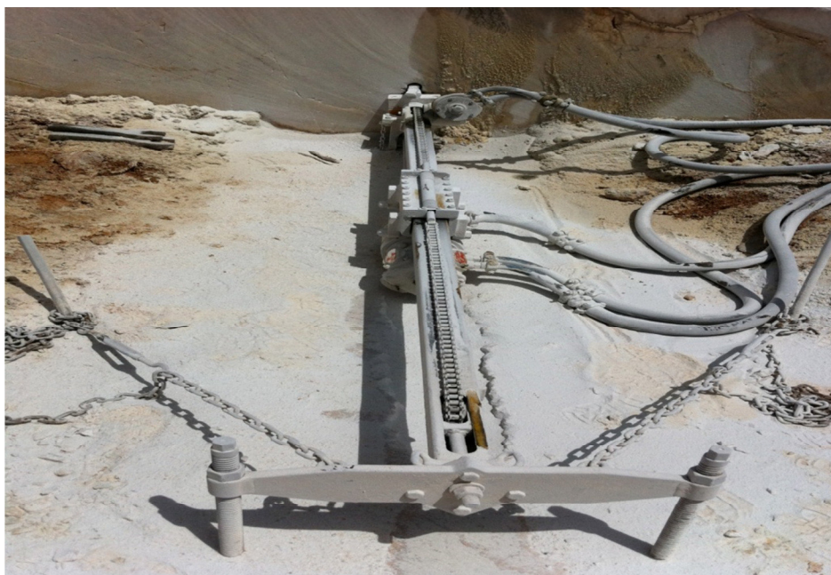
Foto 2.7 – Ilustração da perfuração do furo horizontal com fundo-furo, pedreira Wood Stone (Foto: Autor).
