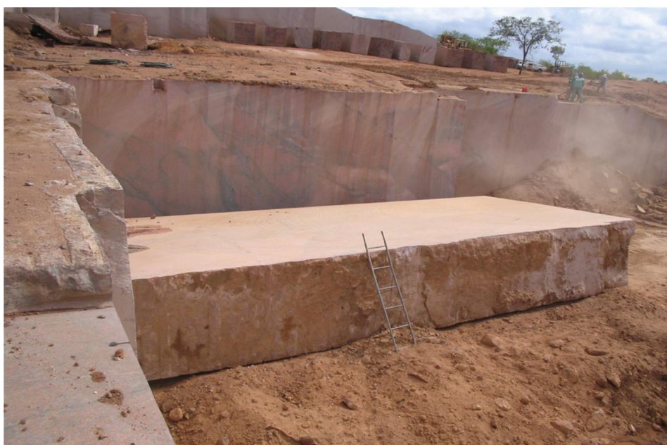
Foto 2.6 – Pedreira granito Red Dragon, mostrando o tombamento do volume primário na “cama ou colchão” em uma lavra de bancada alta (Fonte: Autor).
