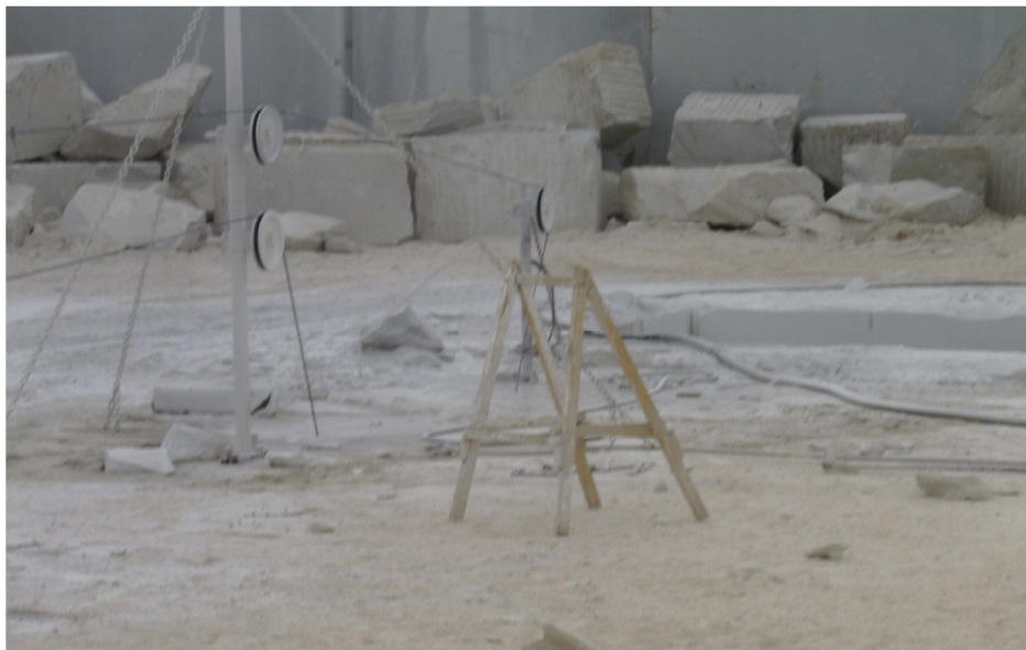
Foto 2.8 – Ilustra colocação de polias-guias de acordo com a direção do corte, pedreira granito Branco Ceará (Foto: Autor).
