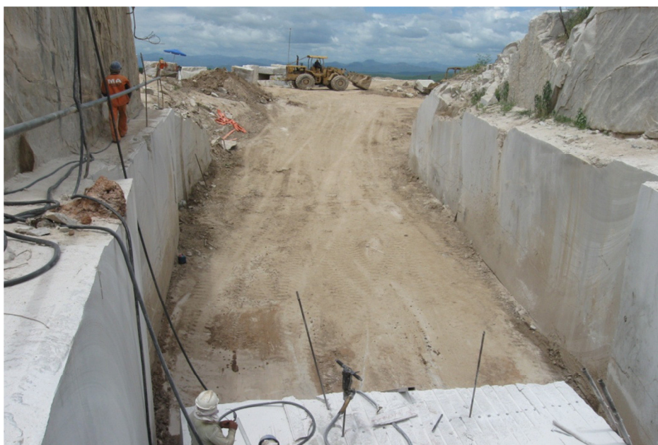
Foto 2.2 Pedreira do granito Branco Nevasca, mostrando cava com rampas ascendentes para escoamento dos blocos (Fonte: Autor)
