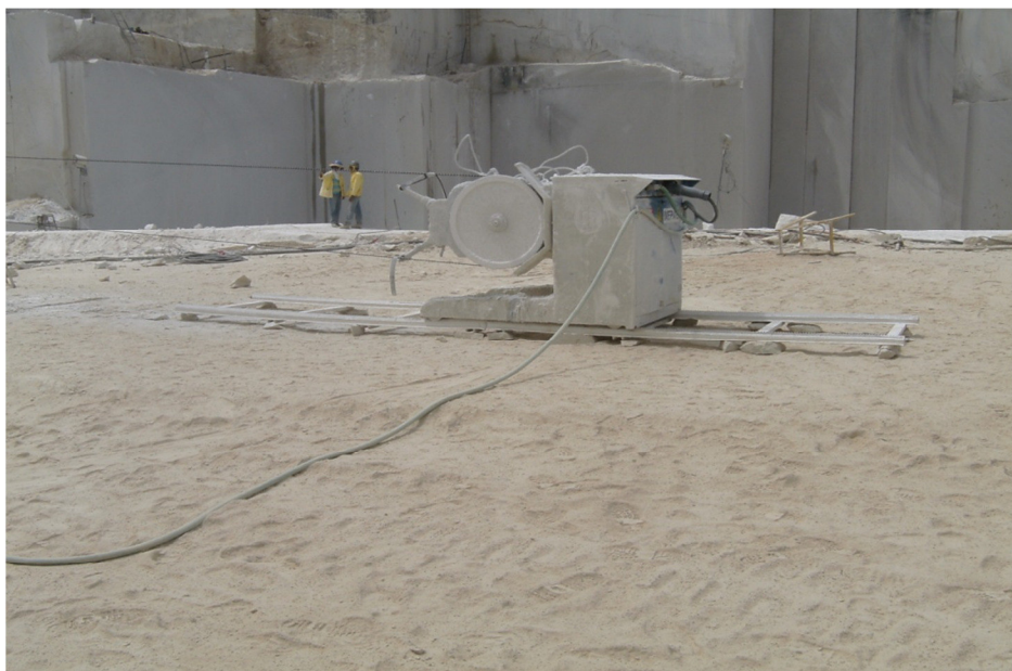
Foto 2.9 – Máquina de fio montada no trilho, pedreira granito Branco Ceará (Foto Autor).
