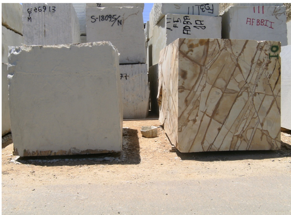
Foto 3.2 – Resinagem do bloco em virtude da intensidade de fraturamento, para suportar esforço provocado na serragem. À direita, bloco não resinado; à esquerda, bloco do mesmo material resinado (Fonte: Autor).
