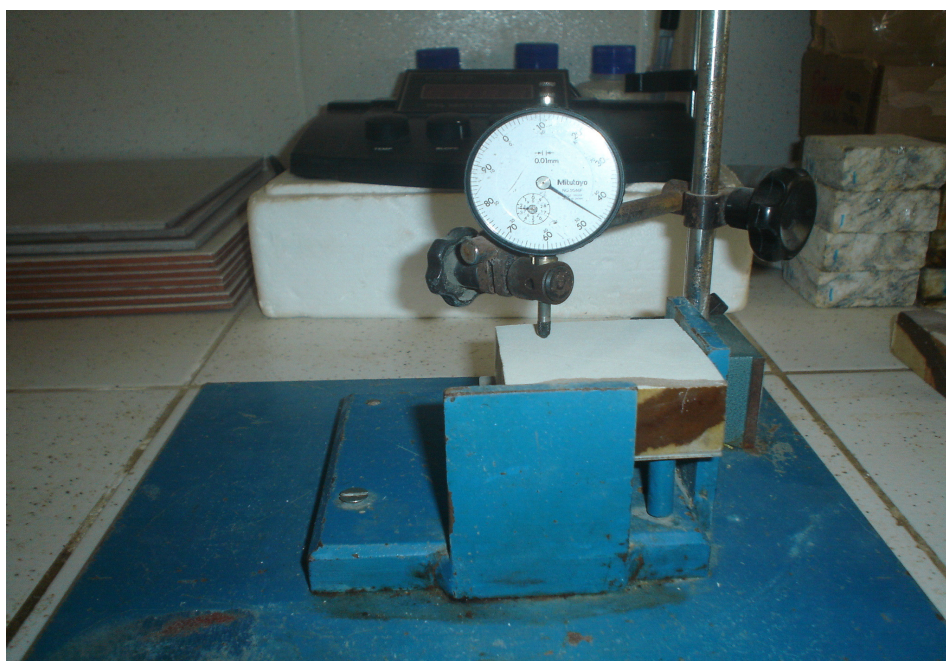
Foto 5.5 Equipamento do NUTEC, utilizado para calcular a aferição da espessura das amostra antes e após o ensaio de desgaste Amsler (Fonte: Autor).
