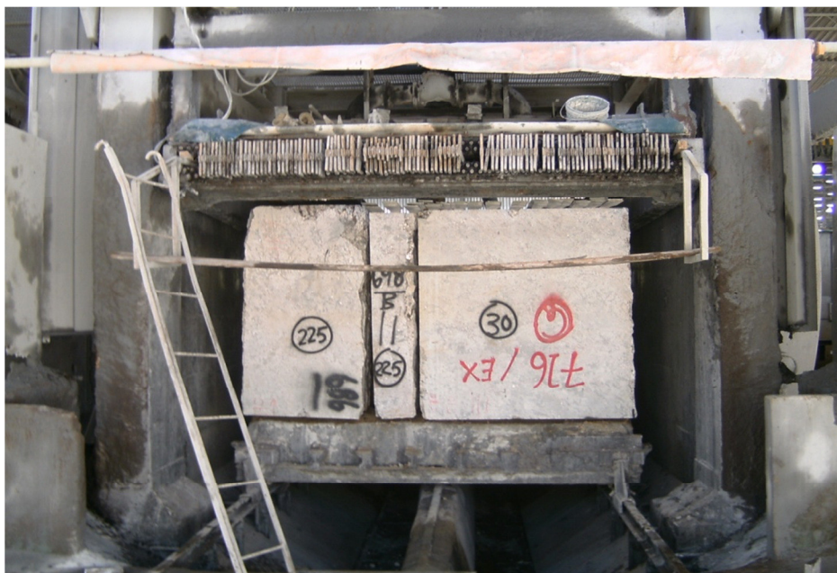
Foto 2.10 – Tear à base de lâminas de aço, usado para serrar blocos de rochas ornamentais, utilizando blocos menores para compor a carga da serragem. Foto tirada na GRANOS - Granitos do Nordeste (Foto: Autor).
