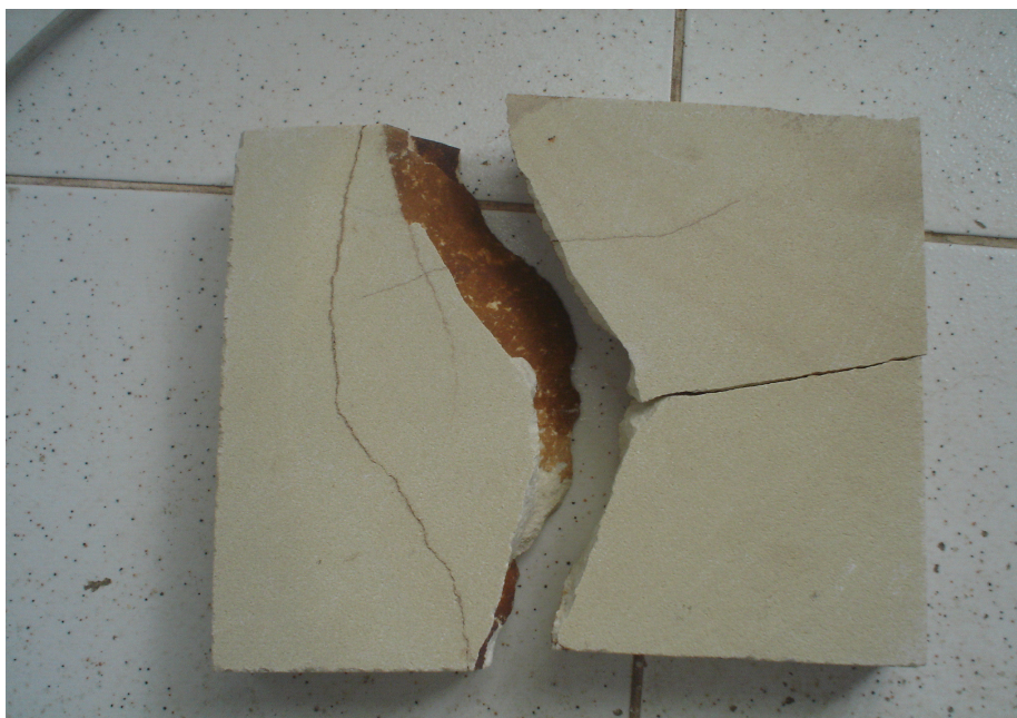
Foto 6.4 Wood Stone não resinado, rompendo ao longo da fratura (Fonte: Autor).
