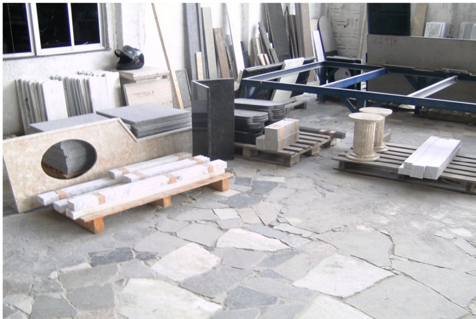
Foto 2.13 – Peças produzidas na marmoraria, JB Mármores e Granitos, após o corte das chapas (Fonte: Autor).
