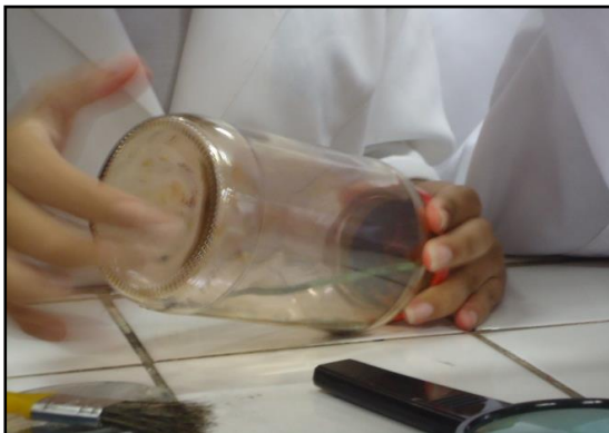
Figura 11 – Revelação da impressão digital com a Técnica do Vapor de Iodo.
