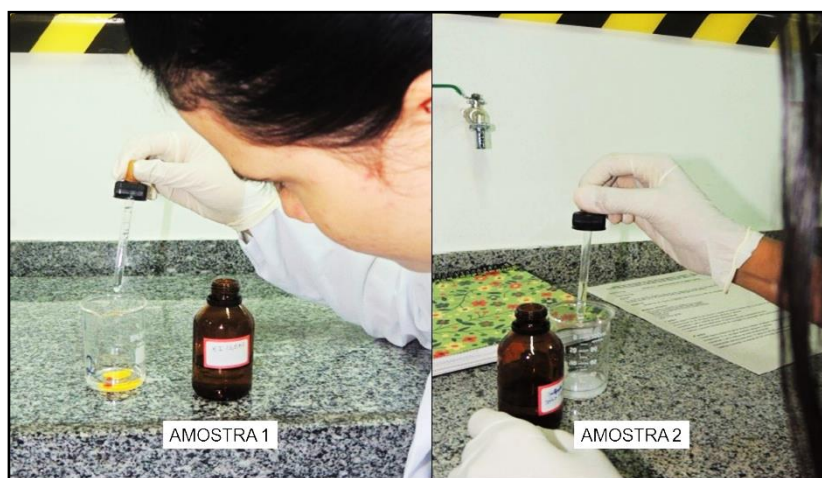
Figura 7 - Reação de precipitação. Amostra 1 – positivo para chumbo. Amostra 2 – teste negativo.
