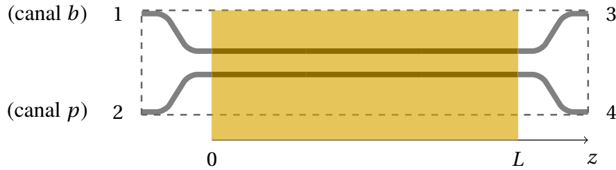
Figura 3.1: Acoplador direcional duplo a fibra óptica: dois canais/quatro portas. Neste esboço os dois canais do acoplador são simétricos (mesmos materiais, geometria e dimensões) e distanciados uniformemente entre si. Em destaque, região onde ocorre o acoplamento modal.
