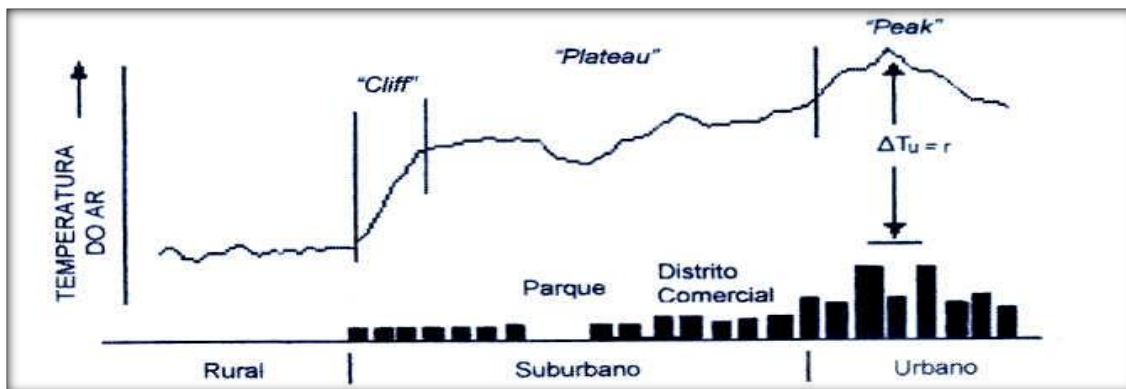
Figura 02 - Representação esquemática de uma secção transversal genérica de uma ilha de calor urbano (OKE, 1978). Fonte: Souza (2011)
