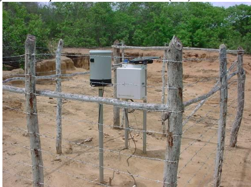
Figura 7 – Estação Pluviométrica Automática (EP1) utilizada no estudo
