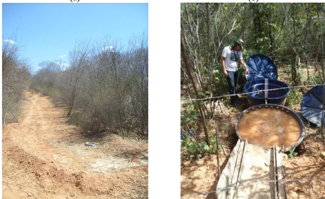
Figura 5 – Segmento monitorado da estrada abandonada (a) e vista de jusante para montante (b) dos reservatórios para acumulação do volume escoado durante eventos de precipitação
