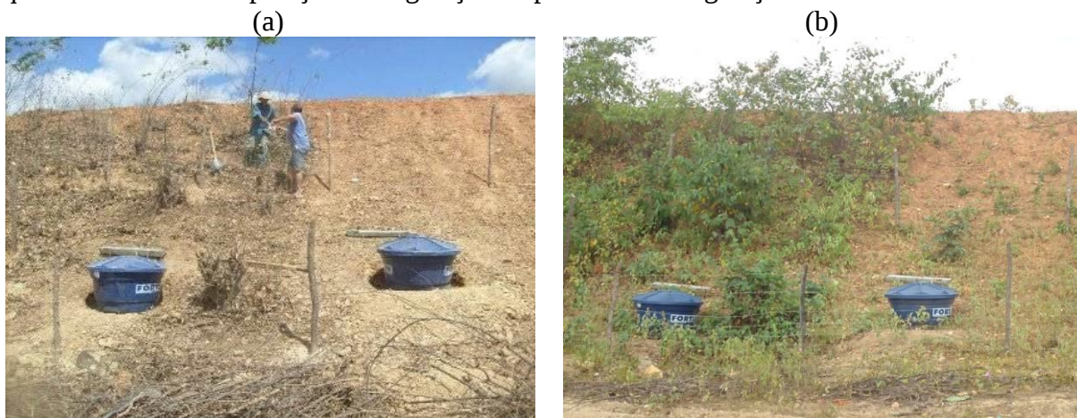
Figura 6 – Talude viário e parcela com e sem vegetação (a) durante instalação das armadilhas para captura de sedimentos em setembro de 2012; (b) final do período de chuvas de 2013 em que se observa recomposição da vegetação na parcela sem vegetação
