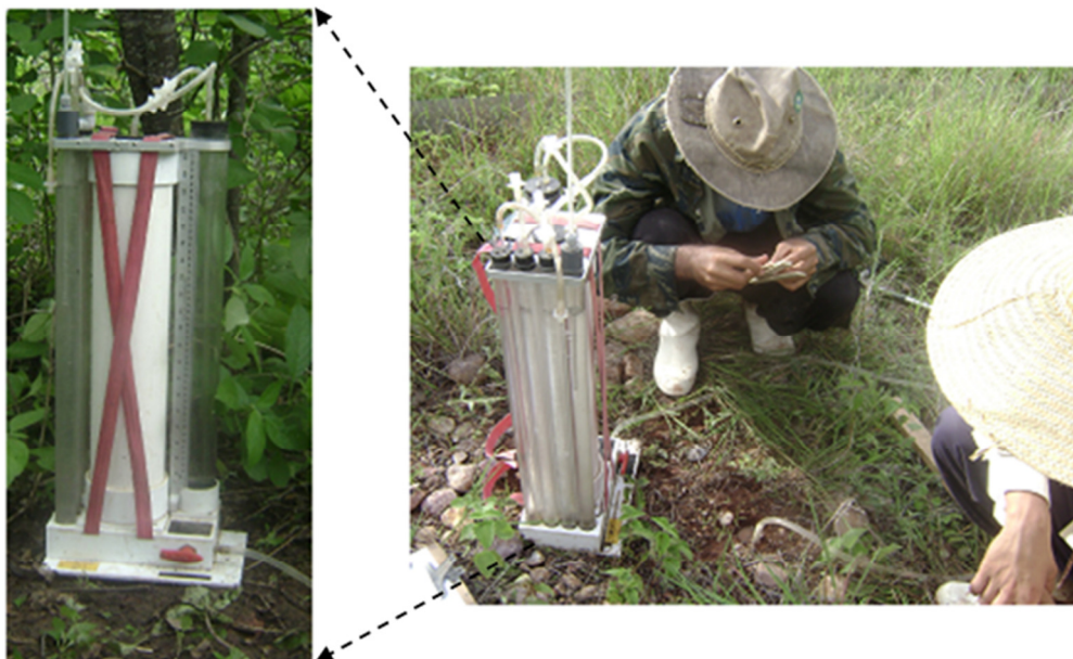
Figura 19 – Equipamento de medição de condutividade hidráulica saturada em campo (Amoozometer)
