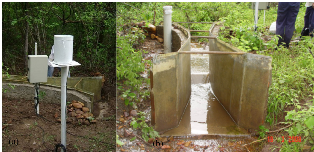
Figura 3 – (a) Modelo do pluviógrafo e (b) calha Parshall instalados nas microbacias experimentais monitoradas em 19-03-2008
