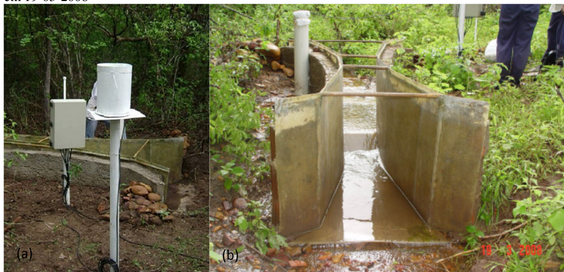
Figura 3 – (a) Modelo do pluviógrafo e (b) calha Parshall instalados nas microbacias experimentais monitoradas em 19-03-2008
