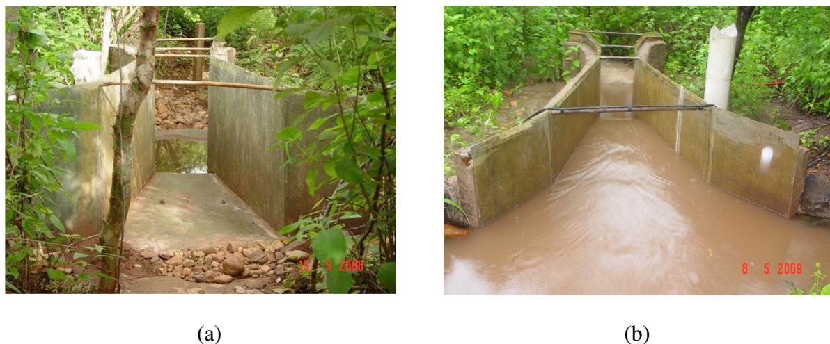
Figura 17 – Detalhe da calha Parshall instalada em campo, (a) visão geral, (b) em funcionamento
