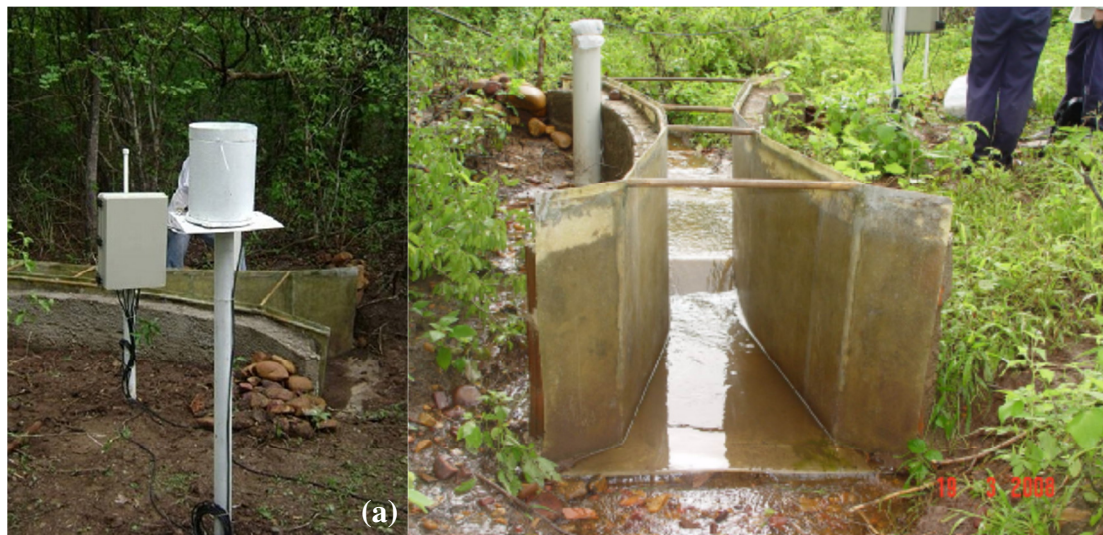
Figura 3 –(a) Modelo do pluviógrafo e (b) calha Parshall instalados na microbacia experimental monitorada
