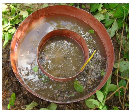
Figura 20 – Anéis instalados em campo para determinação da curva de infiltração pelo método do infiltrômetro de anel com carga variável
