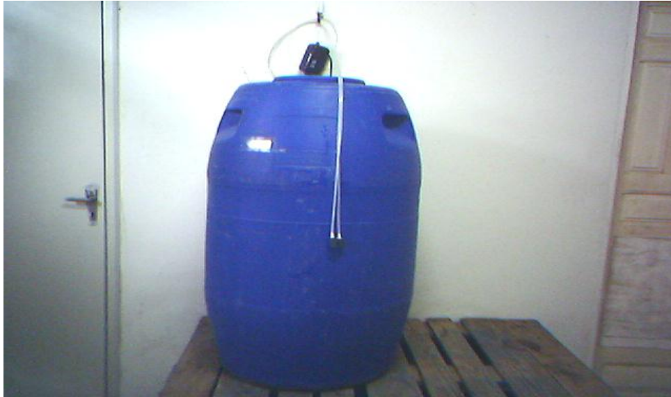
Figura 3.3 – Recipiente para preparo do aditivo biológico, constando de tambor e aerador.
