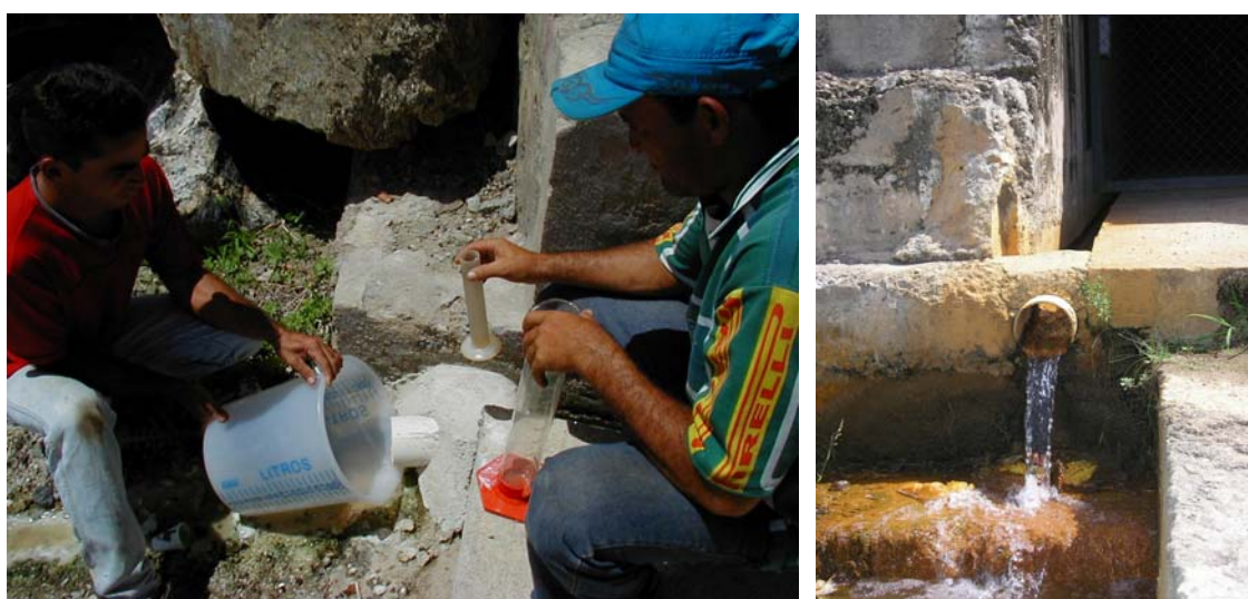
Figura 3.17 – Medição das vazões totais
