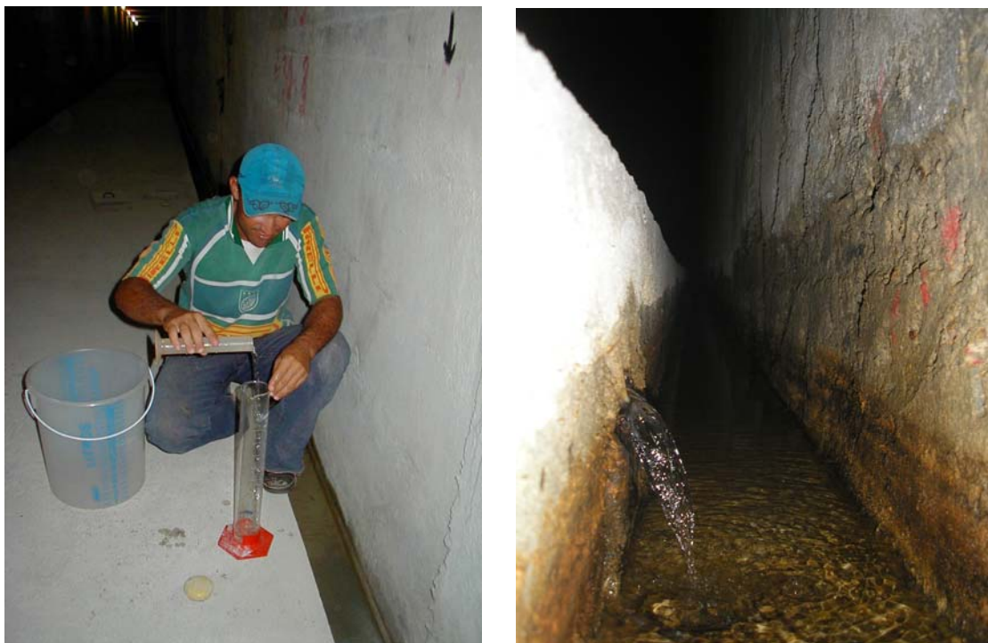
Figura 3.18 – Medição das vazões individuais
