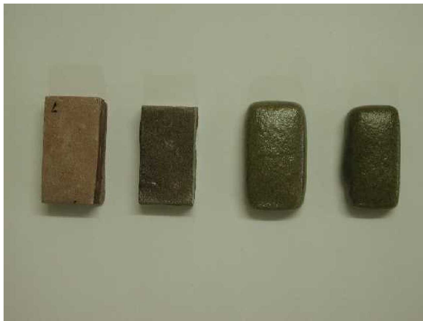
Figura 30: Peças sinterizadas (da esquerda para direita): 1150 °C, 1200 °C, 1250 °C e 1280 °C
