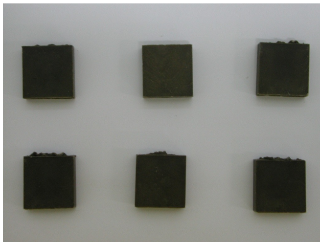
Figura 22: Peças injetadas para retirada do ligante e sinterização
