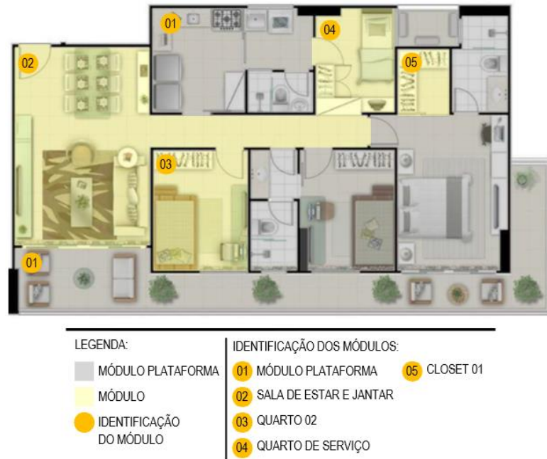
Figura 43 - Identificação dos módulos Opção 01 da torre R do empreendimento NPC – Estudo de caso 02
