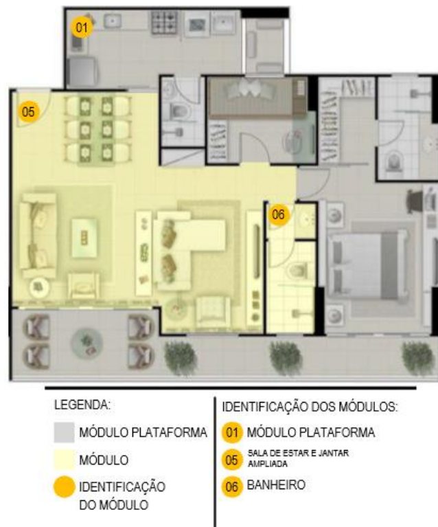
Figura 42 - Identificação dos módulos Opção 02 da torre T do empreendimento NPC – Estudo de caso 02
