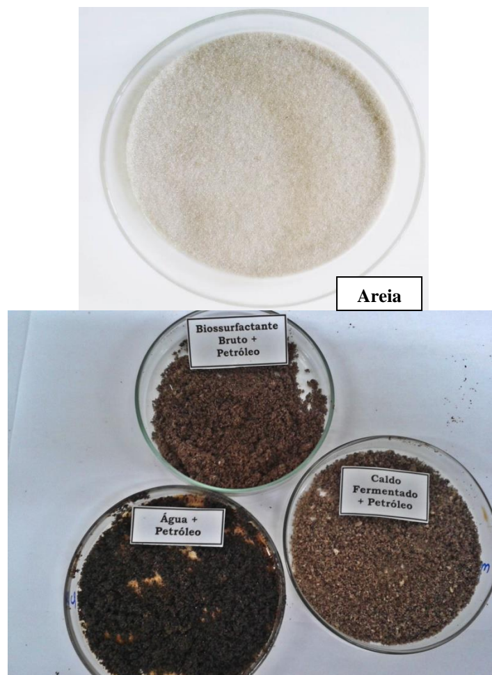
Figura 20 – Na imagem superior: areia limpa sem contaminação. Imagem inferior: areia contaminada com petróleo após tratamento com água, caldo fermentado e solução do biossurfactante bruto.
