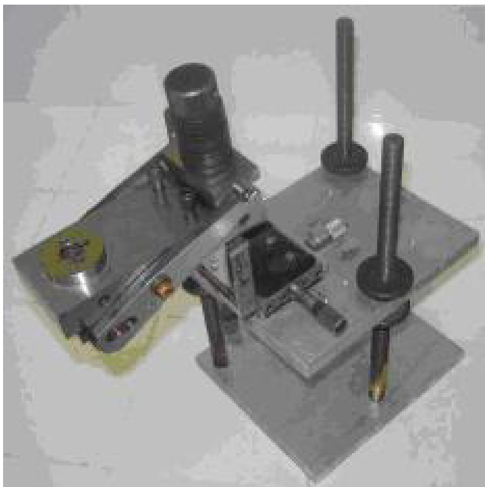
Figura 17: Representação esquemática de uma célula de pressão a extremos de diamante montada sobre uma mesa com deslocamento XYZ.
