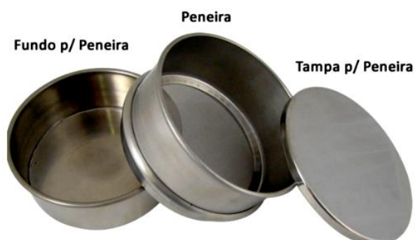
Figura 58: Peneira inox. Malha com abertura de 150 \mu\text{m} (mesh 100).
