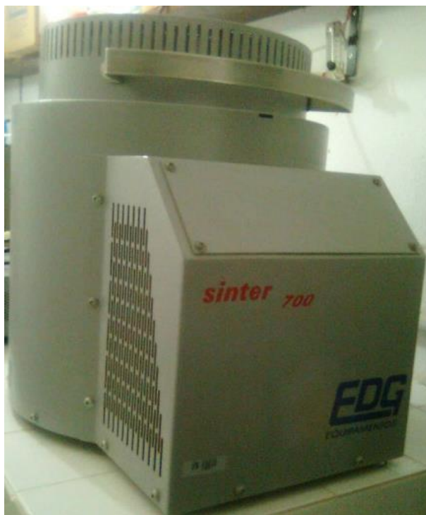
Figura 61: Forno de micro-ondas EDG Sinter-1700, com limite máximo de temperatura de 1700°C.
