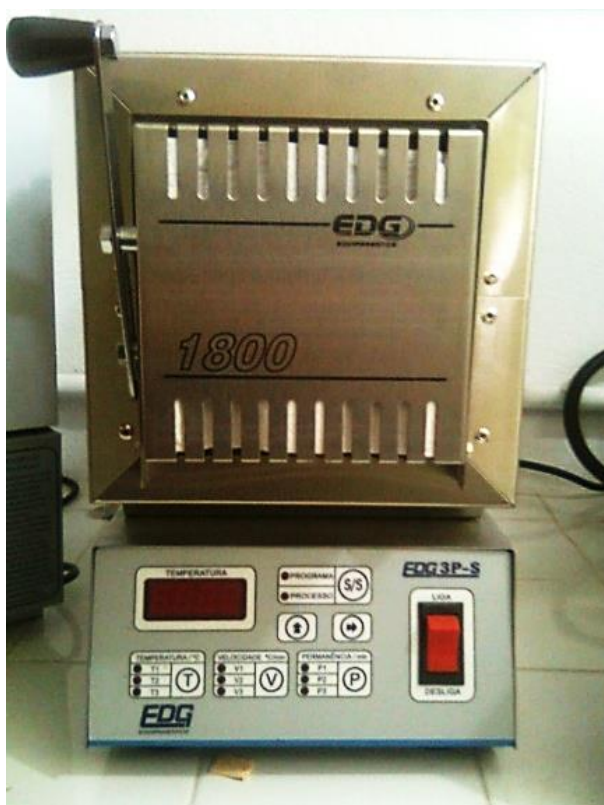
Figura 60: Forno mufla EDG 1800, com limite máximo temperatura de 1200^{\circ}\text{C} .
