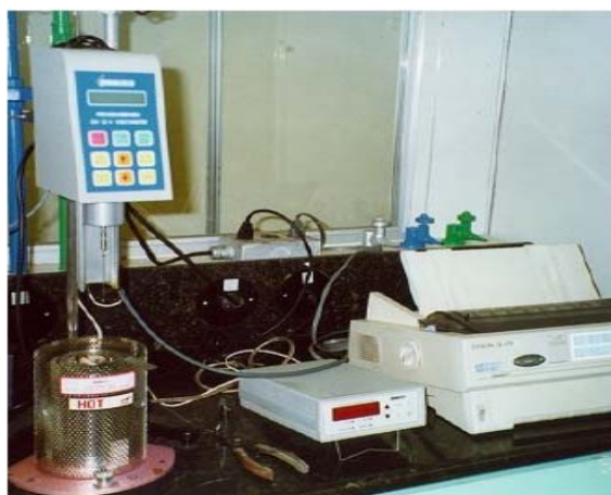
Figura 13. Viscosímetro rotacional cilíndrico BROOKFIELD modelo DVII+ (extraído de Bringel, 2007).
