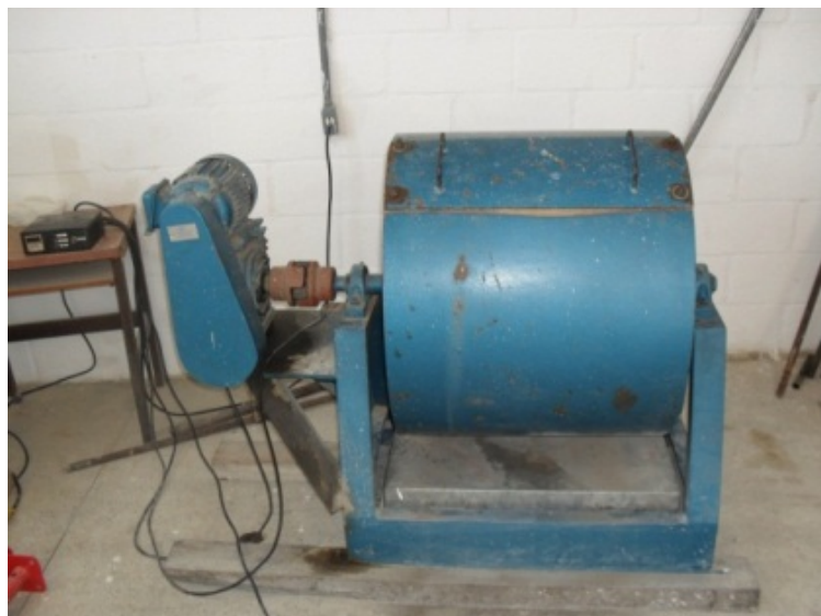
Figura 19. Equipamento de abrasão Los Angeles utilizado para o ensaio de desgaste Cântabro.
