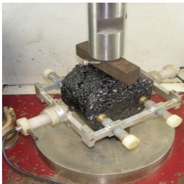
Figura 20. Corpo de prova durante realização do ensaio de MR.
