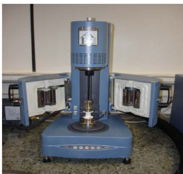
Figura 14. Reômetro de cisalhamento dinâmico (DSR) (extraído de Bringel, 2007).
