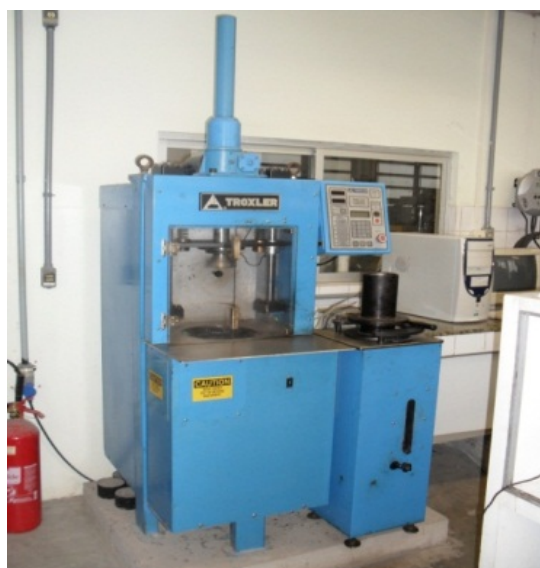
Figura 16. Compactador giratório Superpave (CGS) (extraído de Ribeiro, 2011).
