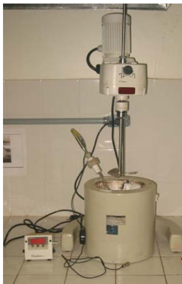
Figura 4.6 - Misturador Fisatom equipado com controle de temperatura e agitador mecânico de baixo cisalhamento.
