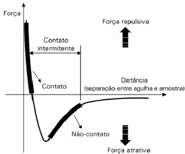
Figura 2.10 - Esquema de forças envolvidas na MFA em algumas de suas diferentes formas de varredura (BERNADES FILHO e MATTOSO, 2003).
