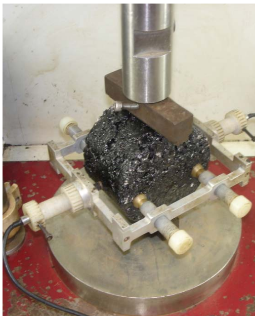
Figura 4.15 - Corpo de prova acomodado no suporte utilizado para aplicação de carga e suporte utilizado para fixação do LVDT.
