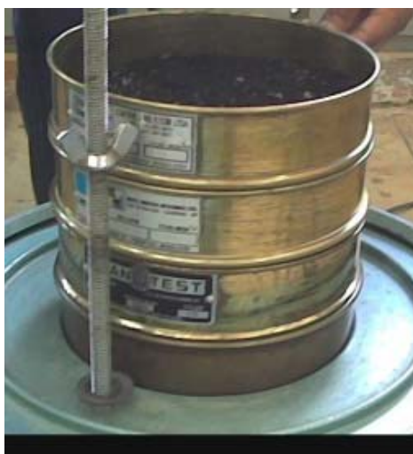
Figura 4.3 - Ilustração do peneiramento mecânico usado para classificação granulométrica do EVAR.
