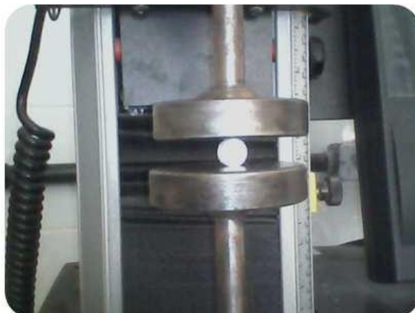
Figura 5. Sistema do ensaio de tração por compressão diametral.
