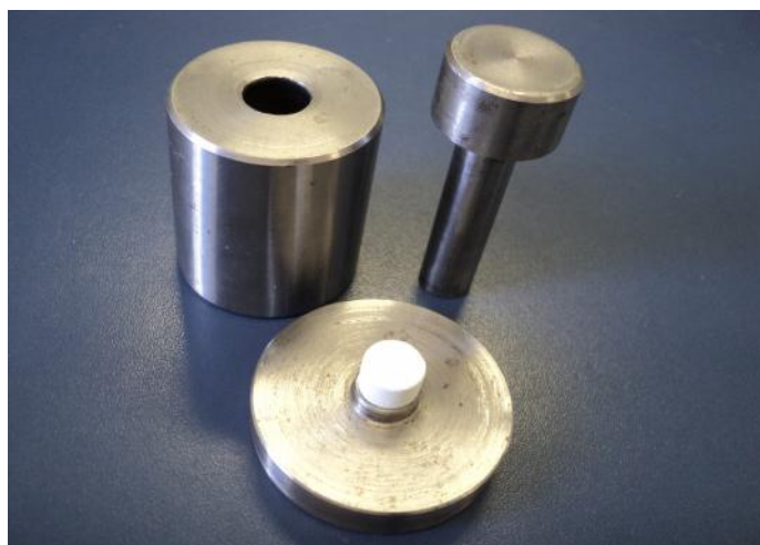
Figura 2 – Molde cilíndrico de aço carbono usado na prensagem dos pós.
