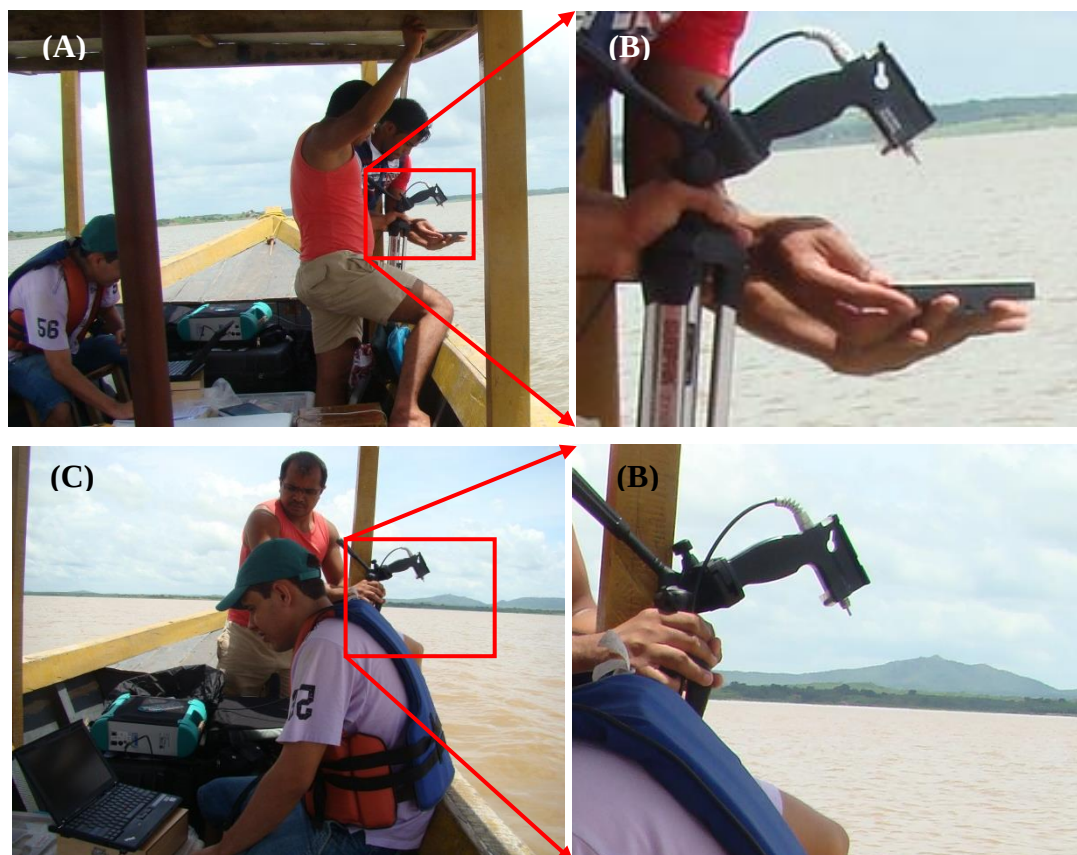
Figura 40 - Leitura da placa lambertiana (A), zoom da leitura da placa (B), leitura da radiância espectral do sistema aquático (C), zoom da leitura da radiância espectral do sistema aquático (D) procedimentos realizados para a coleta de dados radiométricos no reservatório Orós, Ceará
